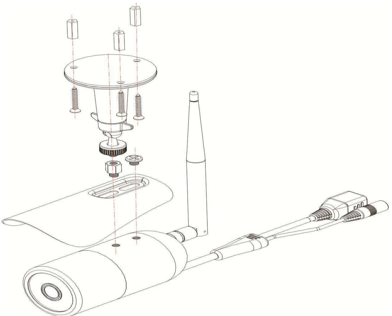
Kamera je vodotěsná, včetně konektorů. Pokud nejsou konce kabelů prostrčeny skrz stěnu, je potřeba umístit je do vodotěsné kovové krabice. Pokud používáte WiFi, po provedení počátečního nastavení stačí pouze napájecí kabel. POE kamera bude potřebovat buď síťový a napájecí kabel, nebo pouze síťový kabel připojený k routeru, který je kompatibilní se standardem 802.3af.
