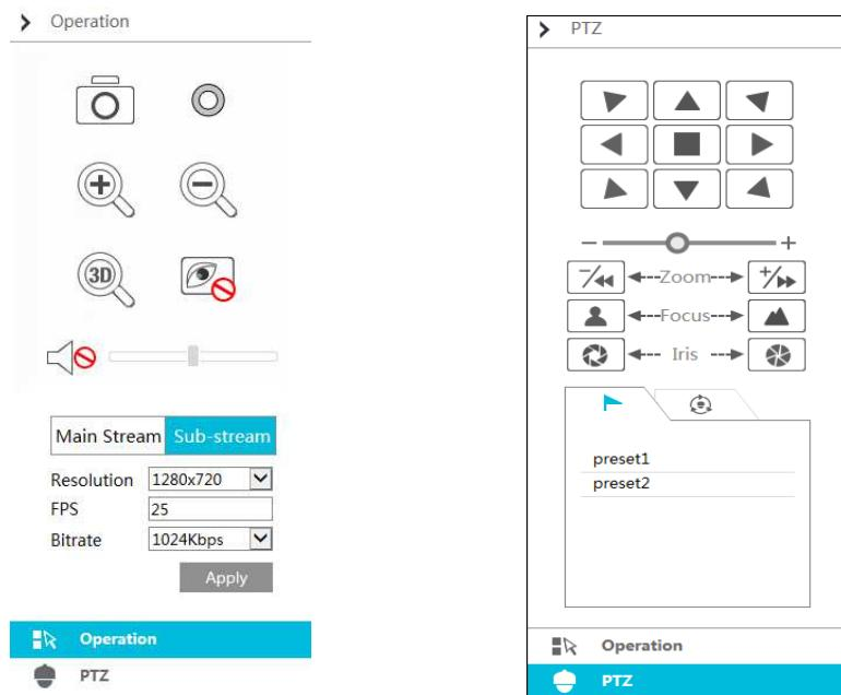
Označte kameru a klikněte na „Main stream“ pro přepnutí živého videa a záznamu kamery do hlavního streamu. Označte kameru a klikněte na „Sub-stream“ pro přepnutí živého videa a záznamu kamery do sub-streamu. U položky „Resolution“ můžete nastavit rozlišením obrazu, u položky „FPS“ můžete nastavit snímkování (počet snímků za sekundu), u položky „Bitrate“ můžete nastavit přenosovou rychlosť. Nakonec klikněte na „Potvrdit“ pro uložení změn.
